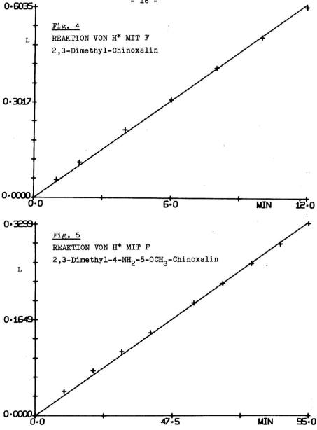
Es wurde L = - ln (1 - 2 ·  $\frac{F_0}{H_0^*}$  +  $\frac{F}{H^*}$ ) gegen die Zeit aufgetragen, weil die Farbstoffkonzentration infolge des etwa zehnmal grösseren Extinktionskoeffizienten genauer messbar ist als H\*, vgl. Anhang 5.3.
