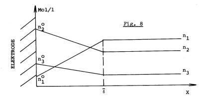
$\rm n_1$  strömt infolge des Konzentrationsgefälles in Richtung der Elektrode, an welcher Elektronen ausgetauscht werden. Es entsteht ein Gefälle des Reduktionsgrades.  $\rm n_1$ ,  $\rm n_2$  und  $\rm n_3$  können miteinander nach
