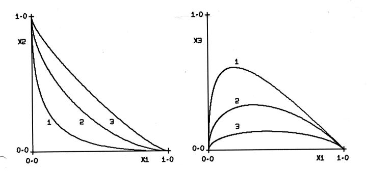
Fig. 5 Gleichgewichtskurve für  $R^* = 1$ , N = 3. 1) K = 10, 2) K = 1, 3) K = 0.1
